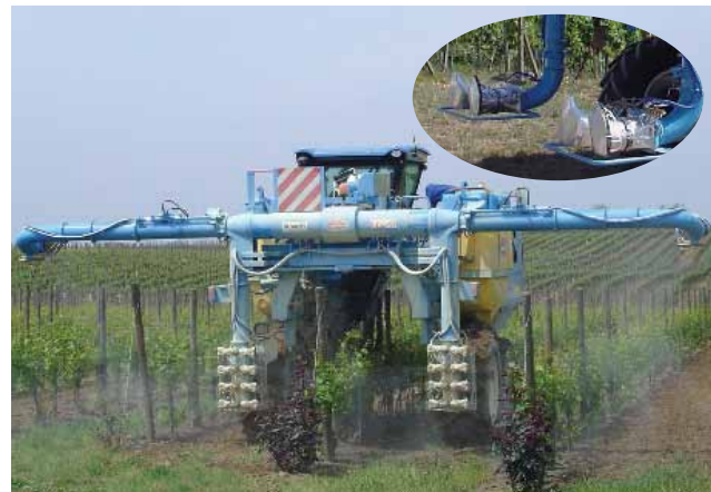
(E) - Trattamento con vendemmiatrici scavallanti e particolare di un distributore di altro tipo (New Holland - Braud; Martignani)
