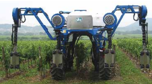
(D) - Vendemmiatrici con telaio a U rovescio predisposta per i trattamenti antiparassitari in grado di lavorare 4 filari (New Holland - Braud; VMA)
