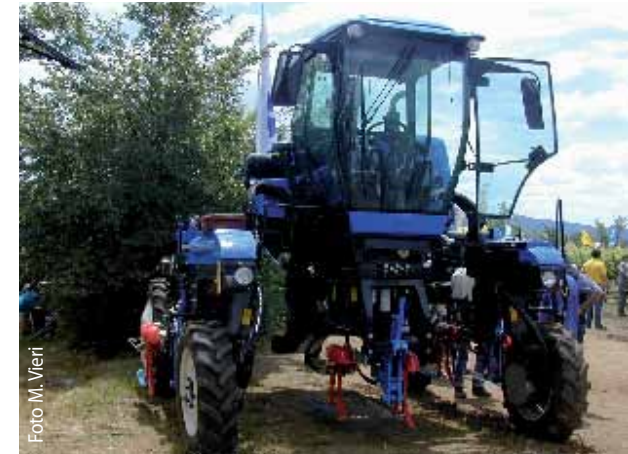
(H) - L'accoppiamento di utensili per la lavorazione del terreno si sta estendendo per l'indubbio vantaggio di poter effettuare più operazioni nello stesso passaggio. Gli utensili collegati sono per lo più piccoli coltivatori data la non elevata capacità di traino del telaio motorizzato a portale. Interessante, ma molto complessa da regolare, è l'applicazione di lame scavallanti (ovvero retrattili in corrispondenza della vite o del tutore) che lavorano sotto il filare (New Holland - Braud; Nardi)
