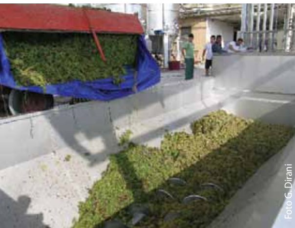
(C) - La tramoggia di ricezione funziona con una o più coclee. Nel caso non sia presente un'adeguata protezione fisica, può essere presente un dispositivo elettronico che arresta l'impianto in caso di caduta accidentale
