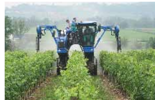
(G) - Vendemmiatrici multifunzione con cabina di comando posta lateralmente rispetto all'asse della macchina (New Holland - Braud; VMA)
