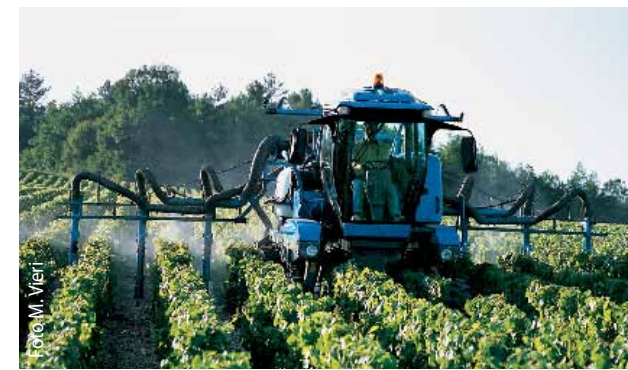
(F) - Trattamenti antiparassitari con vendemmiatrici scavallanti multifunzione. L'interfila molto stretta e la disposizione pianeggiante consente di lavorare nove file contemporaneamente. Si noti come la cabina di comando sia posta in posizione centrale rispetto all'asse della macchina (New Holland - Braud)
