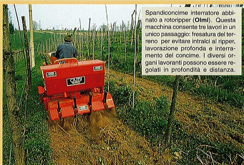
Spandiconcime interratore abbinato a rotoripper (Olmi). Questa macchina consente tre lavori in un unico passaggio: fresatura del terreno per evitare intralci al ripper, lavorazione profonda e interramento del concime. I diversi organi lavoranti possono essere regolati in profondità e distanza.
