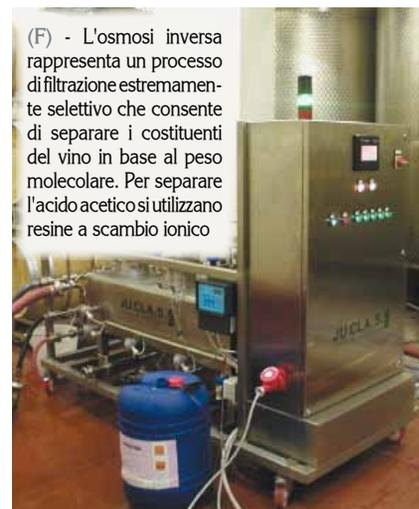
(F) - L'osmosi inversa rappresenta un processo di filtrazione estremamente selettivo che consente di separare i costituenti del vino in base al peso molecolare. Per separare l'acido acetico si utilizzano resine a scambio ionico
