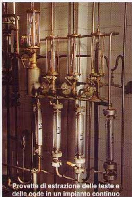
Provette di estrazione delle teste e delle code in un impianto continuo
