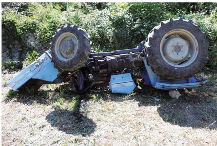
passiva, ovvero lasciare che il ribaltamento avvenga e minimizzarne le conseguenze. Per questo venivano, e vengono tuttora, installate delle robuste strutture protettive, spesso denominate ROPS, dall'acronimo inglese di Roll-Over Protective Structure, ovvero strutture di protezione in caso di ribaltamento. Negli anni queste strutture si sono ampliate ed evolute, e attualmente possono essere classificate in:
