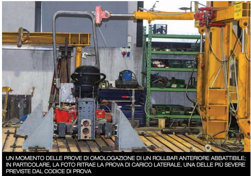
UN MOMENTO DELLE PROVE DI OMOLOGAZIONE DI UN ROLLBAR ANTERIORE ABBATTIBILE; IN PARTICOLARE, LA FOTO RITRAE LA PROVA DI CARICO LATERALE, UNA DELLE PIÙ SEVERE PREVISTE DAL CODICE DI PROVA
