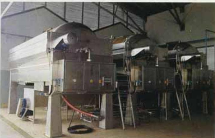
Fig. 18 - Pressa a membrana totalmente realizzata in acciaio inossidabile (Defranceschi).
