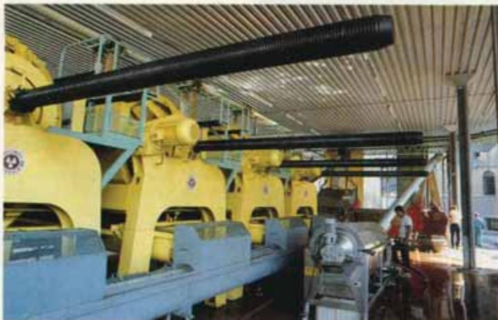
Fig. 10 - Batteria di presse meccaniche orizzontali con un solo piatto e vite esterna (Willmes).
