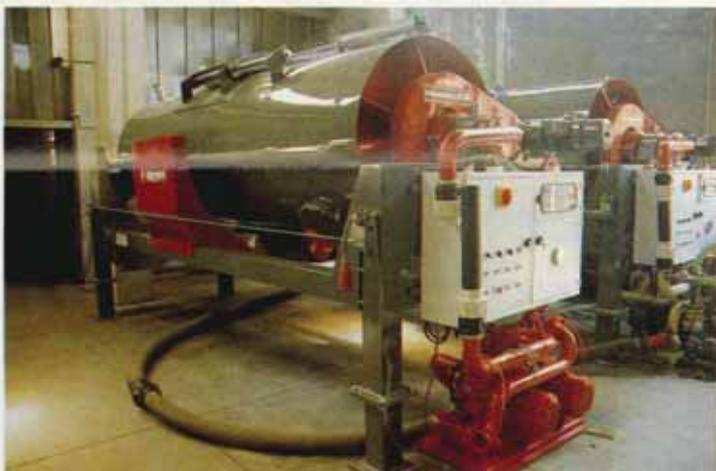
Fig. 13 - Pressa a membrana funzionante ad acqua modello «Pneumopres» (Siprem).
