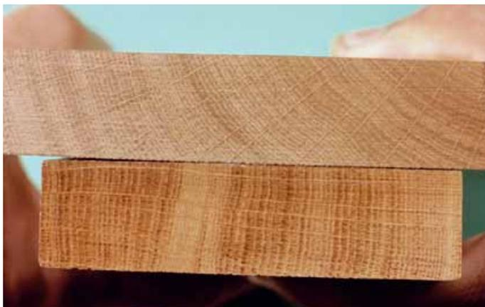
**Foto 2** La doga sopra, ottenuta per spacco, ha tutti i raggi midollari perpendicolari allo spessore, contrariamente a quella sotto, ottenuta per segagione (Gamba)
