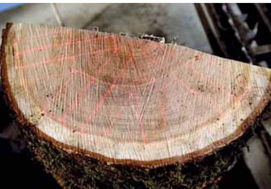
**Foto 1** Al fine di limitare gli sprechi, prima di eseguire il taglio vengono segnate le doghe con l'utilizzo del laser (Radoux)
