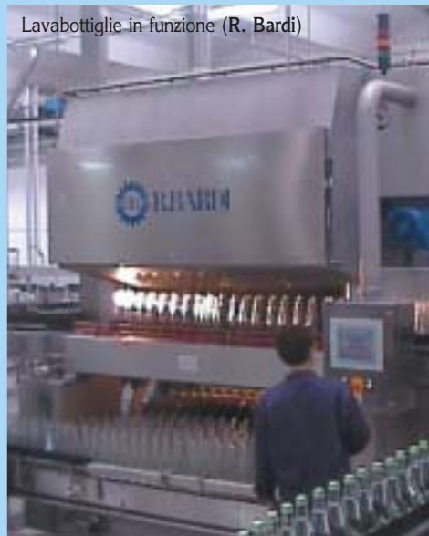
Sciacquatrici - sterilizzatrici da 35.000 a 1.500 bottiglie ora per bottiglie nuove (Poggio)
