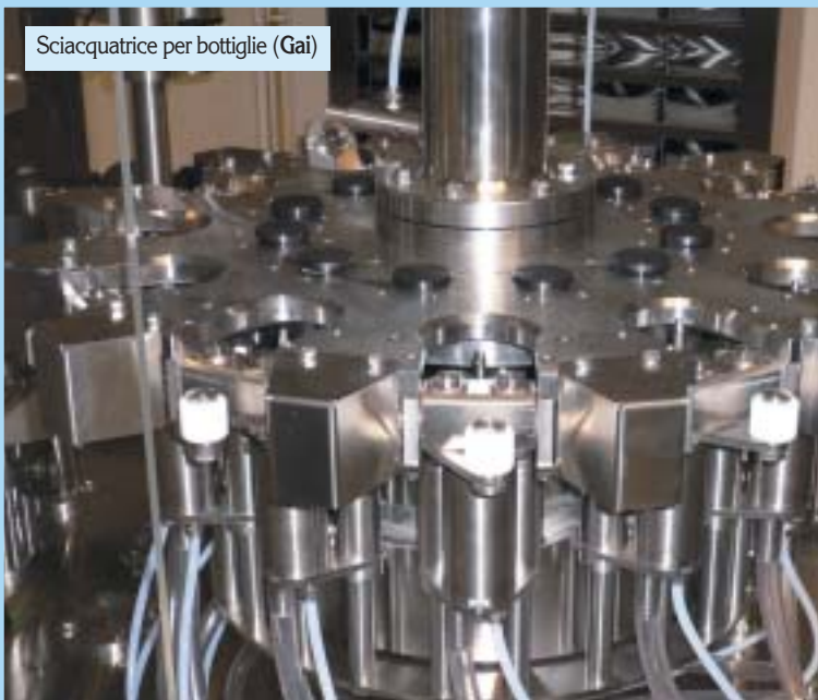
Sciacquatrici - sterilizzatrici da 35.000 a 1.500 bottiglie ora per bottiglie nuove (Poggio)
