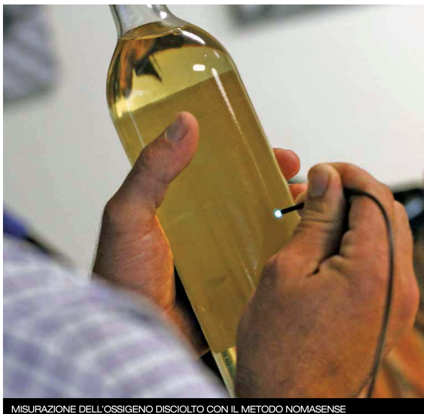
MISURAZIONE DELL'OSSIGENO DISCIOLTO CON IL METODO NOMASENSE
