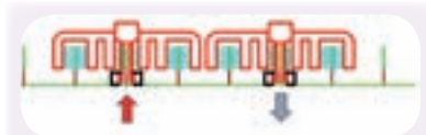
(T) - Irroratrice tri-fila su telaio porta attrezzi. Con questa macchina in un unico passaggio vengono trattati 3 filari interi con diffusori contrapposti e schermatura a recupero di prodotto. Questa è la soluzione che permette di incrementare la capacità di lavoro delle irroratrici a recupero che nella versione trainata possono essere solo bi-fila.
