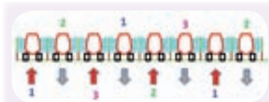
(B) - Irroratrici a fila singola con bagnatura di due facciate di due filari per ogni passaggio. Le frecce indicano il senso di percorrenza ideale dei filari che non è bene venga realizzato con il rientro nel filare immediatamente contiguo visto che saltando 2 file porta allo stesso risultato finale come indicato dalla numerazione. I numeri dei rispettivi percorsi sono posizionati anche in relazione al differente punto di partenza rispetto al filare.
