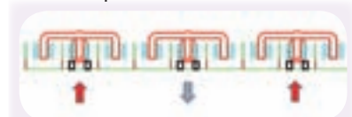
(H) - Irroratrice tri-fila scavallante. Con queste macchine la percorrenza viene ridotta ad un terzo rispetto ai metri di filare complessivi. In un passaggio vengono trattate due file intere con getti contrapposti e due facciate.
