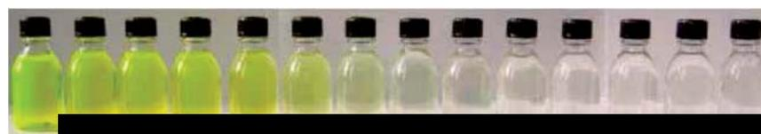
IMMAGINE 9 – POMPANDO CONTINUAMENTE ACQUA PULITA NELL'IRRORATRICE, E AL CONTEMPO SPRUZZANDO LA MISCELA RESIDUA ATTRAVERSO GLI UGELLI, SI OTTIENE RAPIDAMENTE UN'ELEVATA DILUIZIONE DI QUEST'ULTIMA. I CAMPIONI RAFFIGURATI QUI SOPRA (DA SINISTRA A DESTRA, DALL'INIZIO ALLA FINE DELLA PROCEDURA) TESTIMONIANO VISIVAMENTE QUESTO BENEFICIO (FOTO HARALD KRAMER. PROVE DI LAVAGGIO SVOLTE NELL'AMBITO DEL PROGETTO TOPPS)
