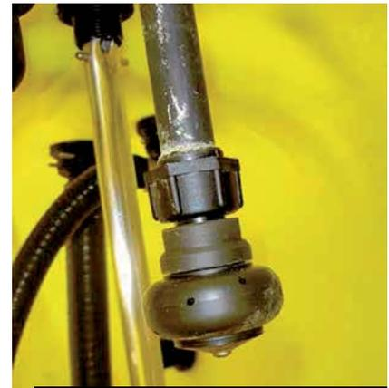
IMMAGINE 3 - UGELLO LAVASERBATOIO DI TIPO ROTATIVO.
