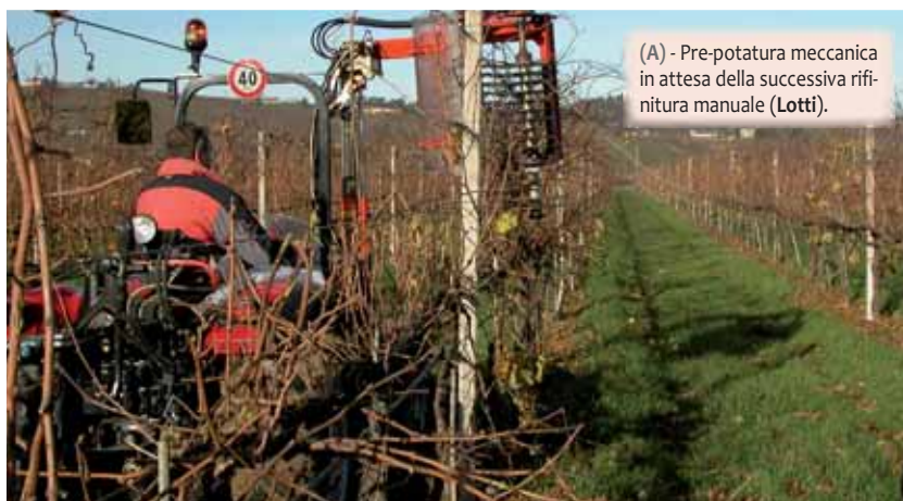
(B) - Operai al lavoro per la rifinitura manuale a seguito del passaggio con la pre-potatrice meccanica.
