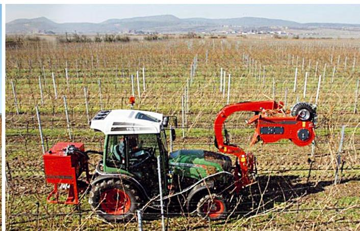
**Foto 3** Due modelli di macchine con dischi controrotanti che intercettano il legno reciso per convogliarlo verso la testa di triturazione. I residui vengono poi dispersi al centro della fila
