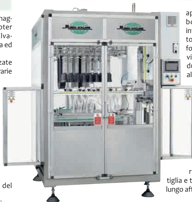
(B) - Incartonatrice per bottiglie orizzontali realizzata già negli anni '90 (Mondo & Scaglione).
