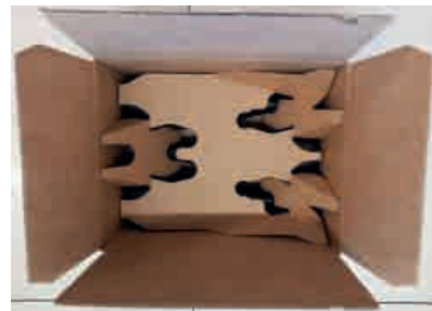
(D) - Particolare del cartone predisposto per bottiglie orizzontali (Mondo & Scaglione).
