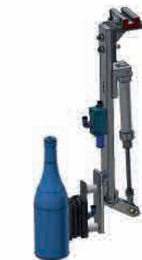
(E) - Testata di presa, con particolare della ventosa che fissa la bottiglia (Mondo & Scaglione).
