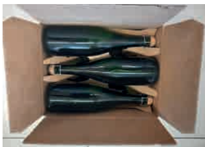
(C) - Cartone con posizionamento meccanico delle bottiglie (Mondo & Scaglione).
