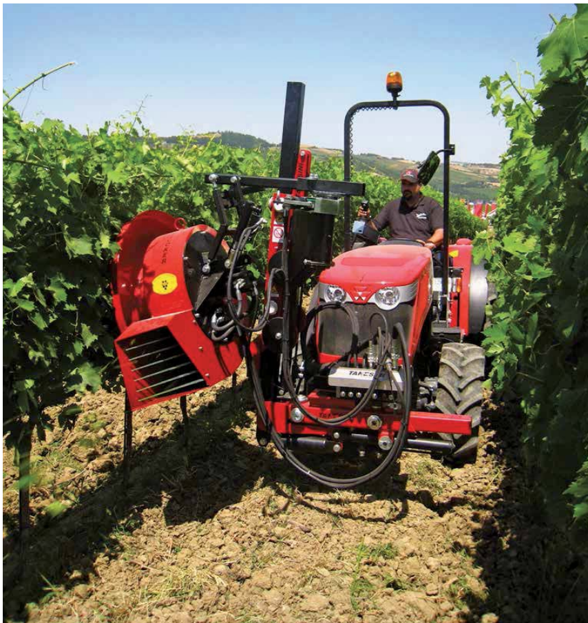
DEFOGLIAZIONE ESEGUITA SU SANGIOVESE IN POST-INVAIATURA CON MACCHINA DOTATA DI ACCOSTAMENTO AUTOMATICO ALLA PARETE.
