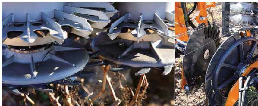
TIPICAMENTE I DISCHI INFERIORI SONO PIÙ TAGLIENTI RISPETTO A QUELLI SUPERIORI, IN QUANTO SI OCCUPANO DEL TAGLIO DI POTATURA VERO E PROPRIO; A DESTRA NOTIAMO DUE DISCHI VERTICALI, INSTALLATI SU MACCHINE DEDICATE A FORME DI ALLEVAMENTO COME IL CORDONE LIBERO
