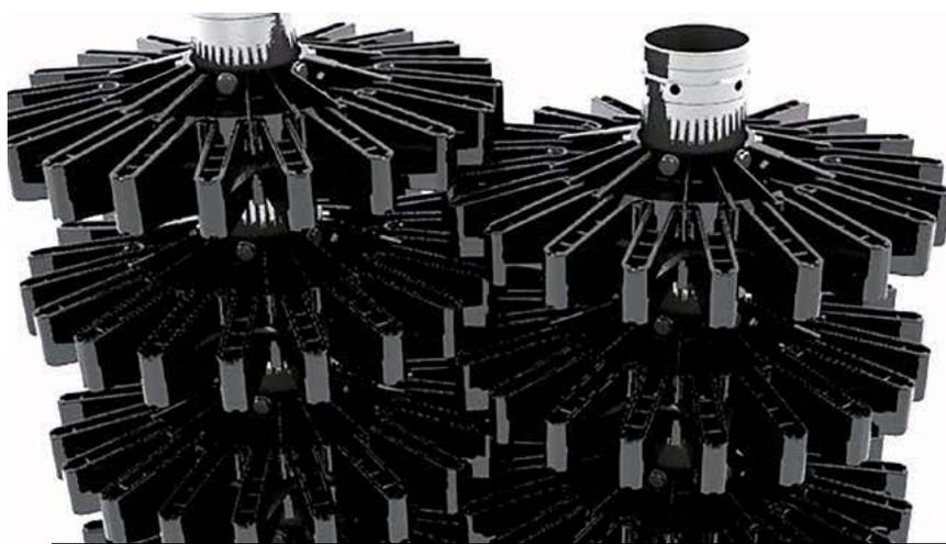
PER EVITARE PROBLEMI AI FILI DI SOSTEGNO DELLA VEGETAZIONE, SPESSO I DISCHI DI TAGLIO SONO PROTETTI DA STRUTTURE IN METALLO O MATERIALI PLASTICI CHE EVITANO IL CONTATTO DEI FILI CON LE LAME
