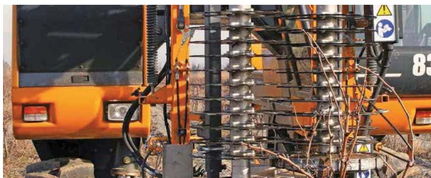
LE POTATRICI A DISCHI SONO FORMATE DA DUE COLONNE DI DISCHI CONTROROTANTI CHE SI INCASTRANO UNA NELL'ALTRA
