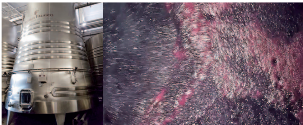
(B) - Vasca attrezzata con Air Mixing e foto dall'alto del cappello nel ciclo di Air Mixing
