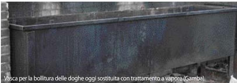
Vasca per la bollitura delle doghe oggi sostituita con trattamento a vapore (Gamba).
