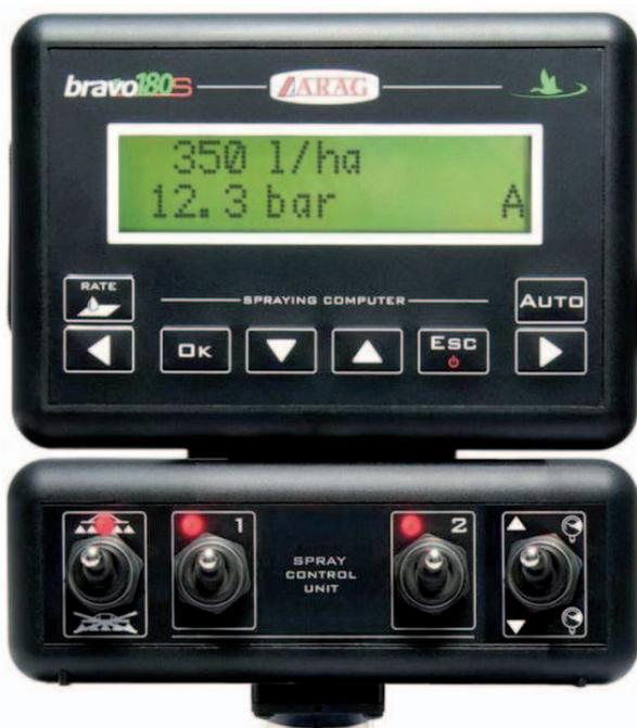
(C) - Computer di bordo per la gestione dell'irrorazione direttamente in cabina.
