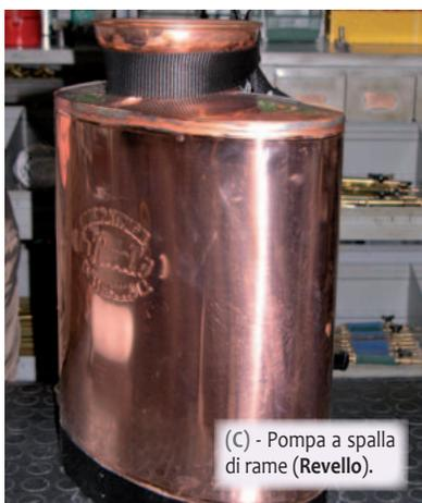
(C) - Pompa a spalla di rame (Revello).
