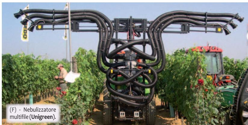
(F) - Nebulizzatore multifilament (Unigreen).
