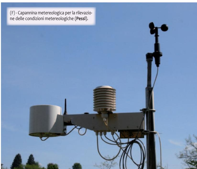
(F) - Capannina meteorologica per la rilevazione delle condizioni meteorologiche (Pessl).
