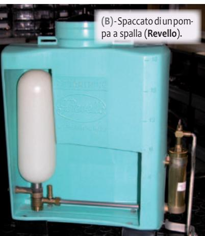
(B) - Spaccato di un pompa a spalla (Revello).
