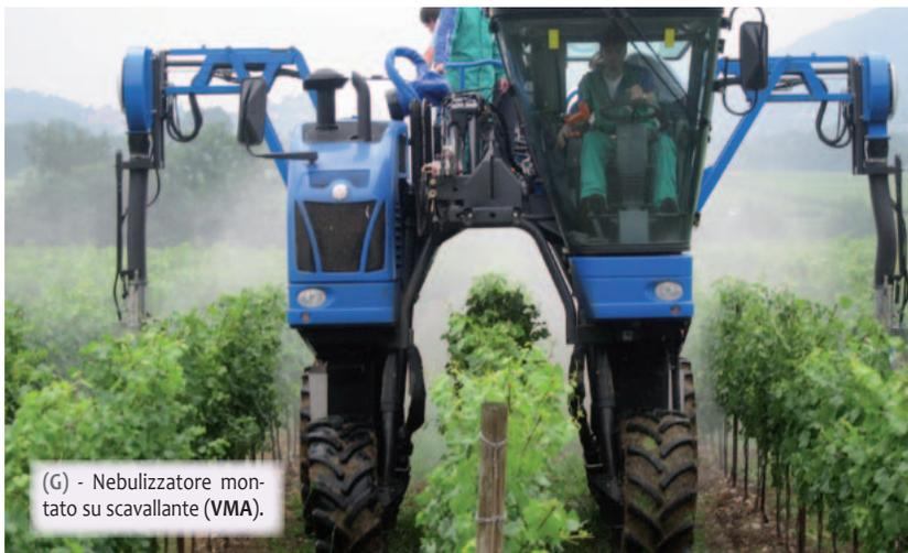
(G) - Nebulizzatore montato su scavallante (VMA).
