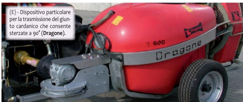
(E) - Dispositivo particolare per la trasmissione del giunto cardanico che consente sterzate a 90° (Dragon).
