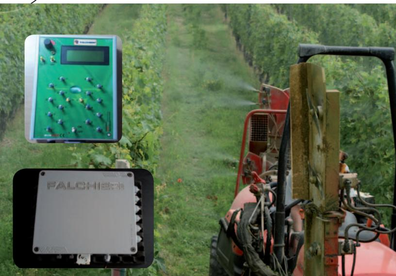
(A) - Grazie all'azionamento delle elettrovalvole poste in prossimità degli ugelli, l'erogatore a rapidissima intermittenza (8-12/s) non raggiunge la copertura al limite del gocciolamento ma produce una bagnatura uniforme formata da depositi leggermente diradati, di circa 1 mm, strettamente necessaria per una protezione efficace (Falchieri).
