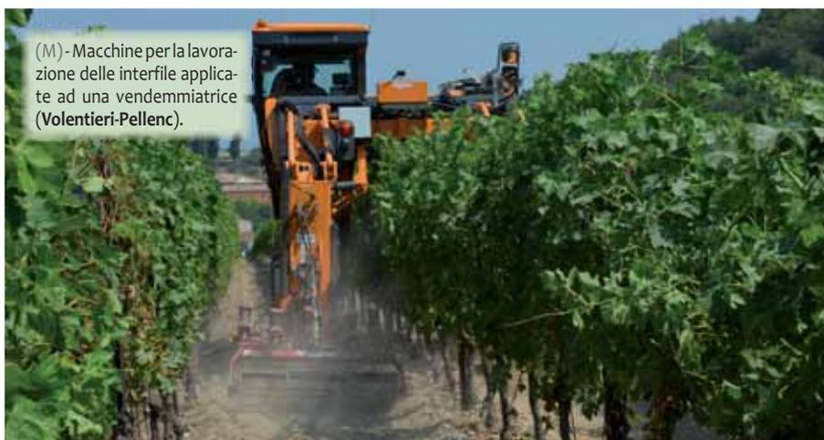
(M) - Macchine per la lavorazione delle interfile applicate ad una vendemmiatrice (Volentieri-Pellenc).
