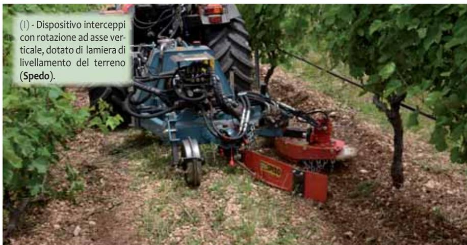
(I) - Dispositivo interceppi con rotazione ad asse verticale, dotato di lamiera di livellamento del terreno (Spedo).
