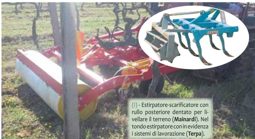
(I) - Estirpatore-scarificatore con rullo posteriore dentato per livellare il terreno (Mainardi). Nel tondo estirpatore con in evidenza i sistemi di lavorazione (Terpa).
