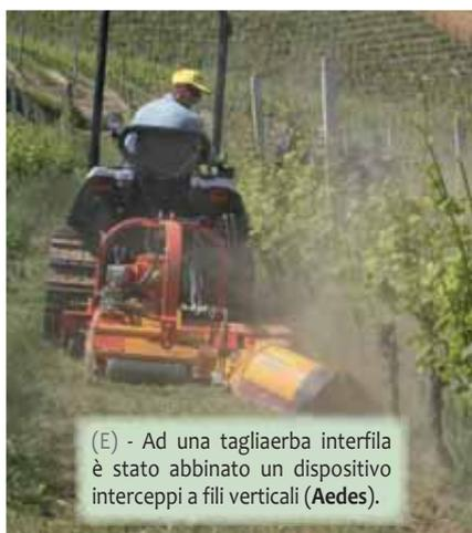
(E) - Ad una tagliaerba interfila è stato abbinato un dispositivo interceppi a fili verticali (**Aedes**).
