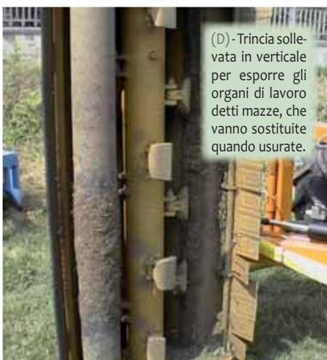
(D) - Trincia sollevata in verticale per esporre gli organi di lavoro detti mazze, che vanno sostituite quando usurate.
