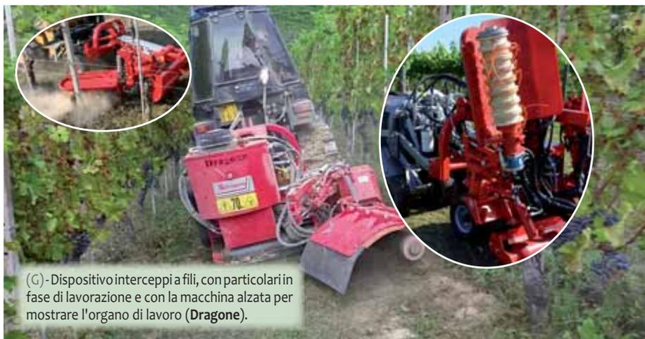
(G) - Dispositivo intercetti a fili, con particolari in fase di lavorazione e con la macchina alzata per mostrare l'organo di lavoro (Dragone).
