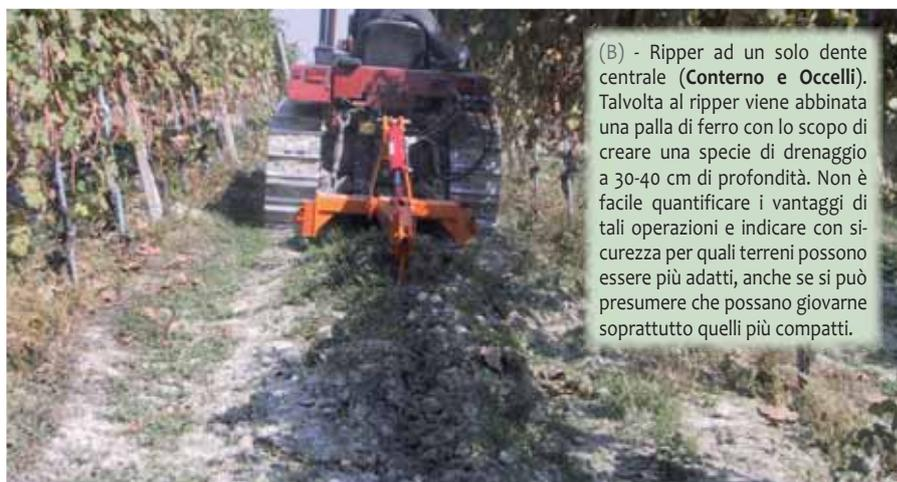
(B) - Ripper ad un solo dente centrale (Conterno e Ocelli). Talvolta al ripper viene abbinata una palla di ferro con lo scopo di creare una specie di drenaggio a 30-40 cm di profondità. Non è facile quantificare i vantaggi di tali operazioni e indicare con sicurezza per quali terreni possono essere più adatti, anche se si può presumere che possano giovare soprattutto quelli più compatti.
