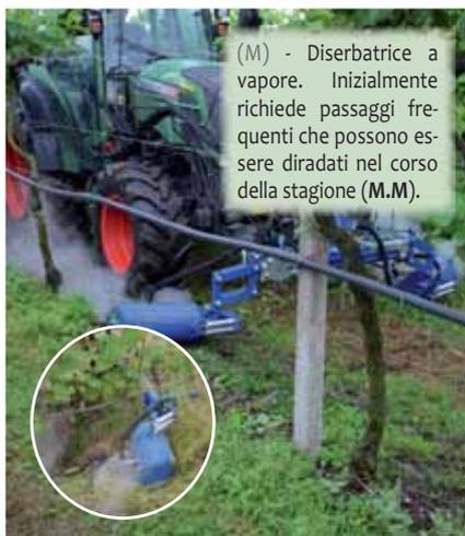
(M) - Diserbatrice a vapore. Inizialmente richiede passaggi frequenti che possono essere diradati nel corso della stagione (M.M).
