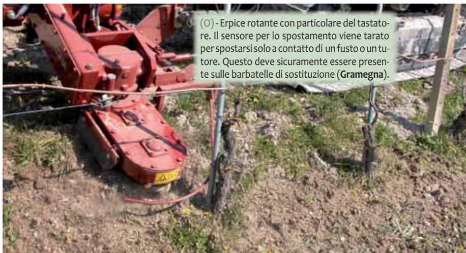
(O) - Erpice rotante con particolare del tastatore. Il sensore per lo spostamento viene tarato per spostarsi solo a contatto di un fusto o un tutore. Questo deve sicuramente essere presente sulle barbatelle di sostituzione (Gramegna).
