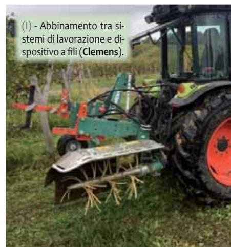
(I) - Abbinamento tra sistemi di lavorazione e dispositivo a fili (Clemens).
