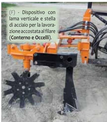
(F) - Dispositivo con lama verticale e stella di acciaio per la lavorazione accostata al filare (Conterno e Occelli).
