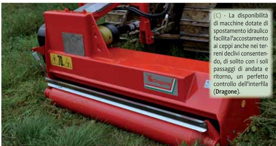
(C) - La disponibilità di macchine dotate di spostamento idraulico facilita l'accostamento ai ceppi anche nei terreni declivi consentendo, di solito con i soli passaggi di andata e ritorno, un perfetto controllo dell'interfila (**Dragone**).
