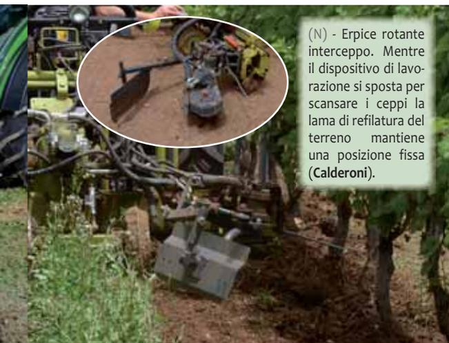
(N) - Erpice rotante interceppo. Mentre il dispositivo di lavorazione si sposta per scansare i ceppi la lama di rifilatura del terreno mantiene una posizione fissa (Calderoni).
