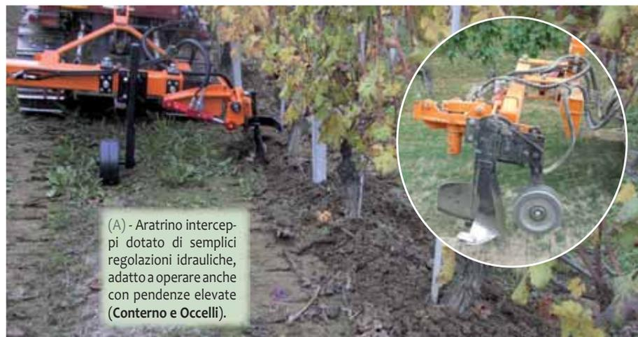
(A) - Aratrino intercetti dotato di semplici regolazioni idrauliche, adatto a operare anche con pendenze elevate (Conterno e Ocelli).
