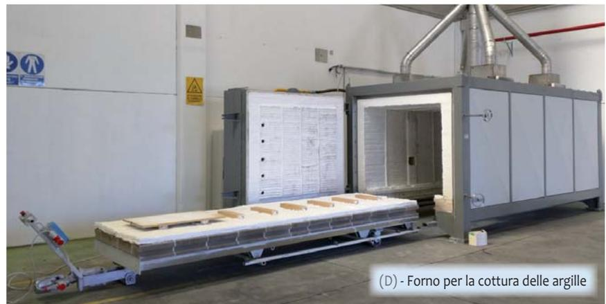
(D) - Forno per la cottura delle argille
