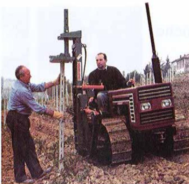
**Piantapali laterale (Colombardo).** Macchina estremamente duttile e di facile impiego, consente di impiantare pali di qualsiasi tipo e dimensione. Con un semplice dispositivo la stessa macchina può essere utilizzata per estrarre il palo.
