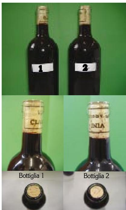
stoccaggio delle bottiglie a 40°C, 50°C e 60°C, mantenendo la bottiglia 1 in posizione verticale e la bottiglia 2 in posizione orizzontale.
