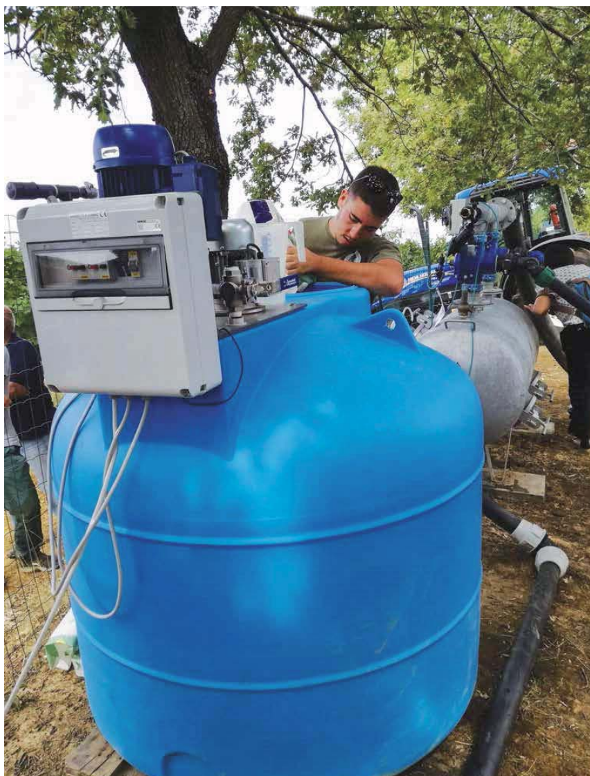
IL "DISSOLVER" È UN'ATTREZZATURA UTILE AD ASSICURARE UNA BUONA SOLUZIONE DI CONCIMI CONCENTRATI PER FERTIRRIGAZIONE E UN RILASCIO REGOLARE DELLA SOLUZIONE.
