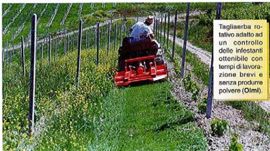
Tagliaerba rotativo adatto ad un controllo delle infestanti ottenibile con tempi di lavorazione brevi e senza produrre polvere (Olmi).
