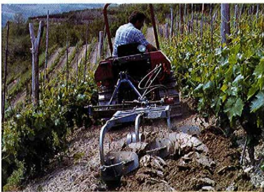
La lavorazione nei terreni pendenti richiede trattori cingolate di adeguata potenza, con una cingolatura sufficientemente larga per ridurre il calpestio e migliorare la stabilità (New Holland). Gli interventi meccanici al suolo possono essere necessari per risistemare la pendenza dei filari, allo scopo di agevolare il transito.
