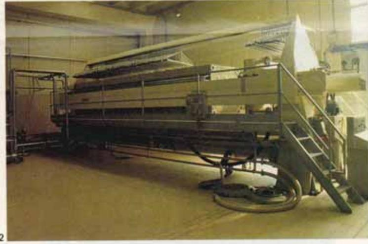
Fig. 1 - Filtro pressa tradizionale, aperto per mostrare la disposizione delle tele. Il liquido viene alimentato dal foro centrale presente sulle piastre, attraversa la tela (di cotone o fibre sintetiche tipo meraklon) sulla quale lascia le impurità e scorre sui canali di supporto per defluire dai rubinetti singoli o confluenti in unico collettore.
