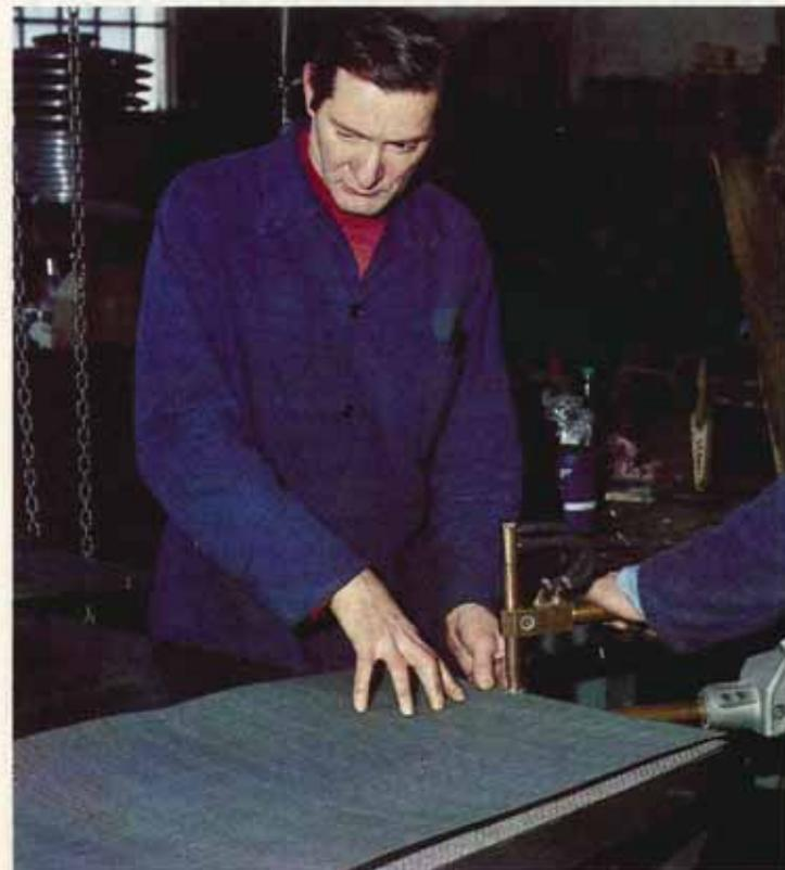
Fig. 9 - Costruzione di piastre verticali per filtro in campana chiusa cilindrica verticale tipo Enoverta (Gianazza).
