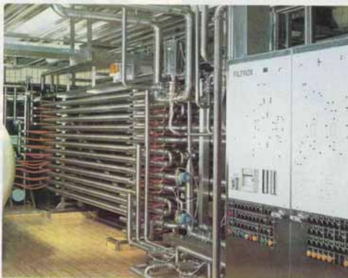
Fig. 13 - Ultrafiltrazione.
