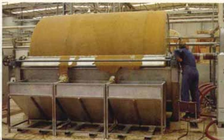
Fig. 4 - Filtro rotativo sottovuoto in funzione (Padovan), con particolare della rimozione di fecce e filtrina.
