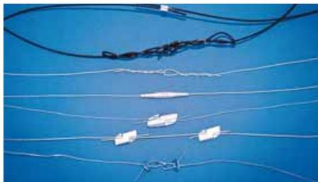
**Foto 9** - I fili di materiali plastici abbisognano di una manutenzione limitata e non necessitano di tendifilo. In caso di taglio accidentale si possono utilizzare gli elementi di giunzione appositi che sono però costosi
