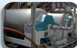
Pressatura con pressa pneumatica ed ottenimento del succo (resa del 70% circa)
