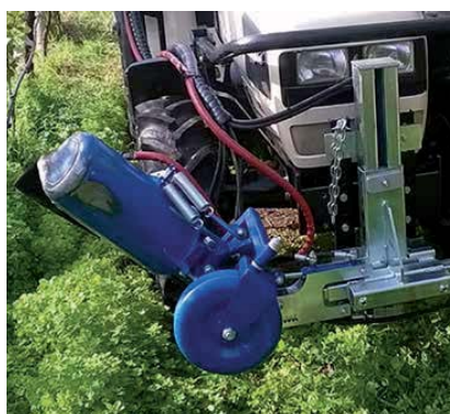
"L'EROGAZIONE DEL VAPORE È AFFIDATA AD UNA BARRA INTERFILARE, IN QUESTO CASO SINGOLA. UNA PICCOLA RUOTA DI APPoggio GARANTISCE IL MANTENIMENTO DI UN'ALTEZZA COSTANTE."
