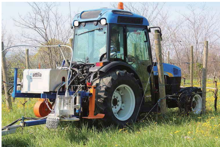
"IL PROTOTIPO DI ATTILA AL LAVORO IN UN VIGNETO: LA MACCHINA È PORTATA AL SOLLEVATORE POSTERIORE, E TRAINA IL SERBATOIO DELL'ACQUA."
