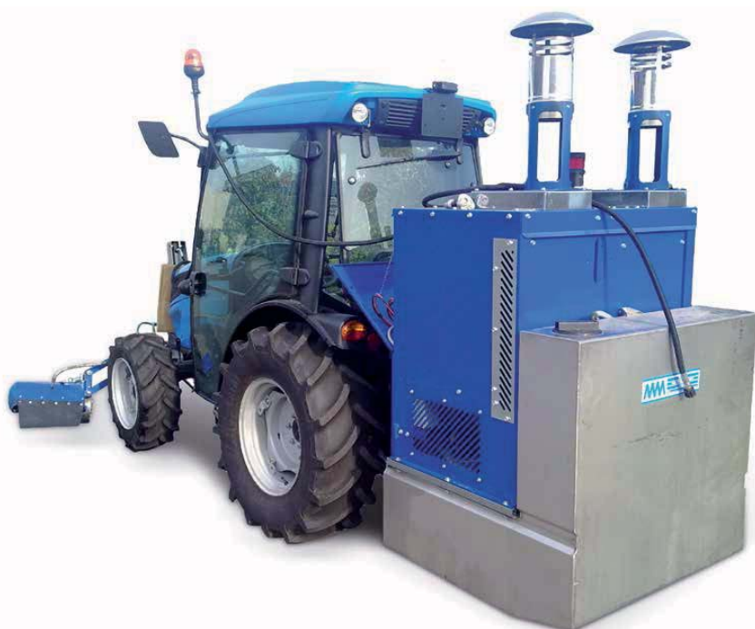
"LA ECOGP È DISPONIBILE ANCHE IN VERSIONE PORTATA ALL'ATTACCO A TRE PUNTI, CON CISTERNA DA 500 O 800 L IN ACCIAIO INOX."
