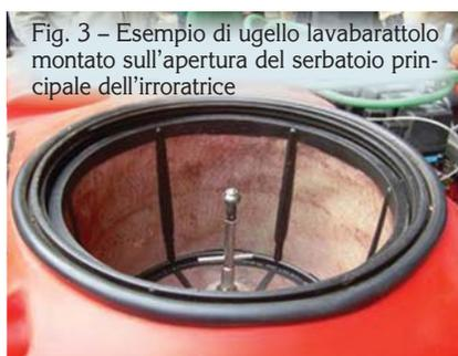
Fig. 3 - Esempio di ugello lavabarattolo montato sull'apertura del serbatoio principale dell'irroratrice
