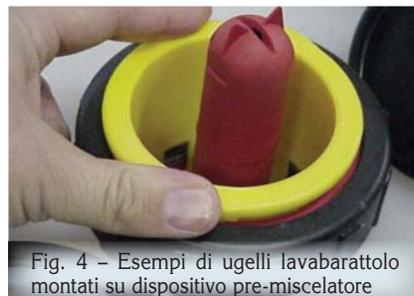
Fig. 4 - Esempi di ugelli lavabarattolo montati su dispositivo pre-miscelatore
