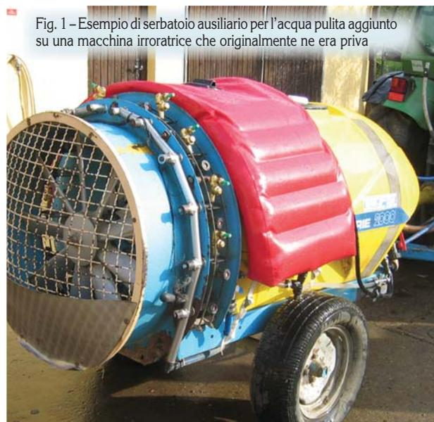
Fig. 1 - Esempio di serbatoio ausiliario per l'acqua pulita aggiunto su una macchina irroratrice che originalmente ne era priva
