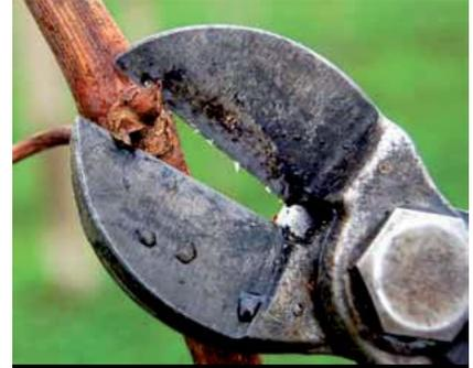
FOTO 2 - LE FORBICI A DOPPIA LAMA PIATTA RAPPRESENTANO UN OTTIMO STRUMENTO DI LAVORO PER LA POTATURA INVERNALE E SONO PARTICOLARMENTE ADATTE PER LA DEGEMMAZIONE
