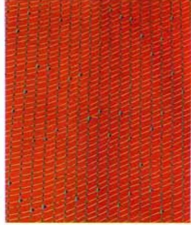
Fig. 3 - La rete dopo il trattamento: si noti la distribuzione abbastanza uniforme del prodotto.
