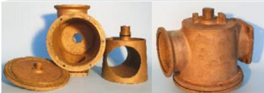
Valvole a maschio o a tronco di cono. Il corpo valvola è a tronco di cono entro cui ruota a perfetta tenuta e mediante leva di comando un otturatore anch'esso di forma tronco-conica, provvisto di foro orizzontale. Ponendo il foro dell'otturatore parallelo ai condotti di passaggio del fluido la valvola viene aperta, mentre ponendo lo stesso foro trasversale a tali condotti essa verrà chiusa.
