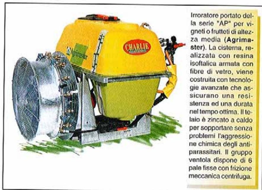
Irroratore portato della serie "AP" per vigneti o frutteti di altezza media (Agrimaster). La cisterna, realizzata con resina isofalica armata con fibre di vetro, viene costruita con tecnologie avanzate che assicurano una resistenza ed una durata nel tempo ottima. Il telaio è zincato a caldo per sopportare senza problemi l'aggressione chimica degli anti-parassitari. Il gruppo ventola dispone di 6 pale fisse con frizione meccanica centrifuga.
