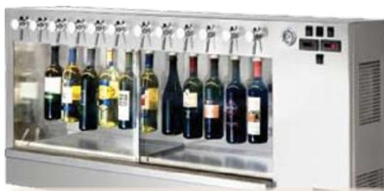
(C) - Spillatori a due vani con regolazione della temperatura bi-zona, per bianchi e per rossi. Man mano che si svuota la bottiglia viene riempita con gas inerte per mantenere inalterato il vino (Vinofreddo)
