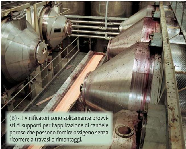
(B) - I vinificatori sono solitamente provvisti di supporti per l'applicazione di candele porose che possono fornire ossigeno senza ricorrere a travasi o rimontaggi.
