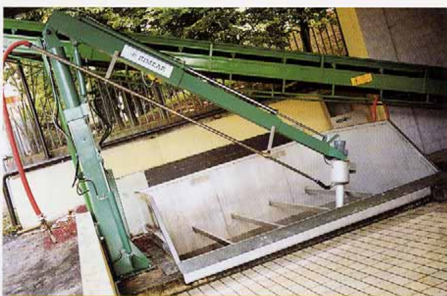
Prelevacampioni di nuova concezione munito di braccio telescopico per operare su un ampio raggio con il minimo ingombro (RIMEAR). Questo strumento, indispensabile almeno nelle cantine di medie e grandi dimensioni, consente di prelevare con rapidità e in modo totalmente meccanizzato un campione di mosto rappresentativo del carico di uva conferito.
