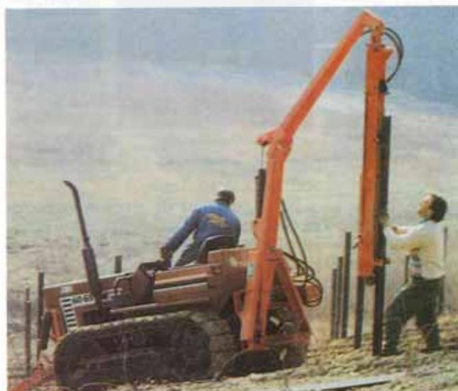
Figura 30 - Piantapali «a pendolo» (Olmi). Il particolare attacco a cerniera posiziona il dispositivo di pressione in verticale quasi automaticamente. Piccole correzioni per ottenere la verticalità perfetta vengono ottenute con i dispositivi idraulici azionati manualmente. La profondità di infissione può essere determinata sulla guida di scorrimento del palo. Per l'espanto dei tutori è in dotazione una apposita staffa.
