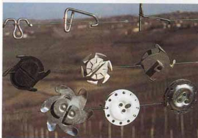
Figura 28 - Tendifili «imarasio» realizzati in lega di alluminio, resistente dal punto di vista meccanico ed alla corrosione. Il modello piccolo può essere impiegato su qualsiasi tipo di filo fino ad un diametro di 3,4 mm, quello grande su fili fino a 6,4 mm (Ferro A).
