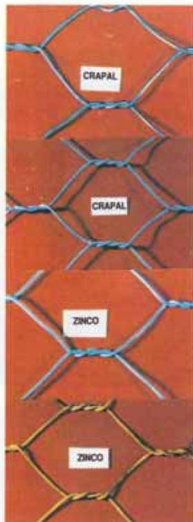
Figura 32 - Risultati di prove di corrosione effettuate su rete protetta con zincatura pesante e rete rivestita con zinco-alluminio «crapal» (TrefilEurope). In alto la rete nuova, sotto la rete dopo 25 cicli di prova Kesternich (atmosfera industriale contenente SO<sub>2</sub>). (Prove effettuate presso l'Istituto Ricerche Breda).
