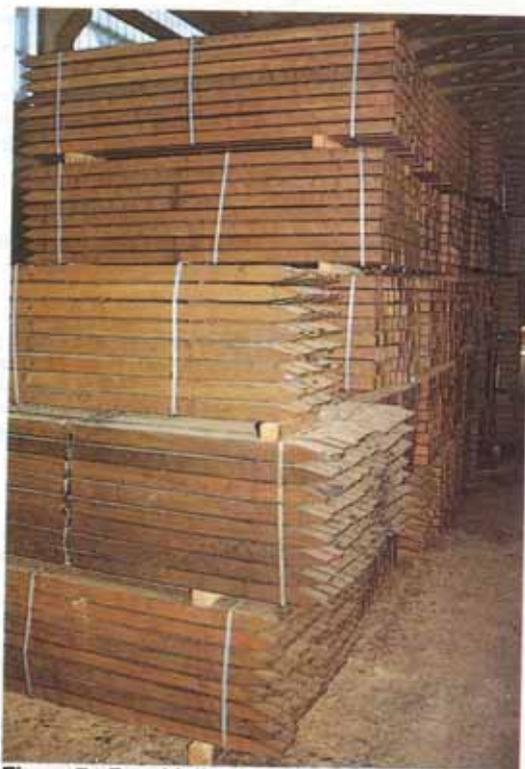
Figura 7 - Pacchi di pali di bongossi, noto anche come azobé, dopo un trattamento impermeabilizzante a base di cere ed altre sostanze che proteggono il legno nei primi anni consentendo una graduale stagionatura ed evitano fessurazioni e deformazioni (TecnoALP).
