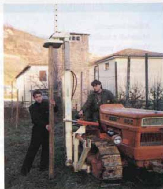
Figura 31 - Piantapali posizionato a fianco del mezzo, abbinabile a qualsiasi trattore a cingoli (Colombardo). Il martinetto idraulico è in grado di conficcare il palo anche se è sprovvisto di punta, anzi questo favorisce la perpendicolarità del piantamento. La stessa macchina può servire per spiantare i pali e, con poche operazioni, si può applicare la trivella.
