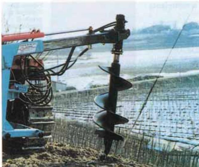
Figura 29 - Trivella applicata al piantapali (Oesse). Il movimento è idraulico con possibilità di rotazione nei due sensi per evitare inceppamenti. Si possono raggiungere profondità di 80-90 cm, anche con inclinazione fino a 45°. La stessa macchina viene utilizzata come piantapali. I pali vengono serrati da manicotti idraulici che consentono, a seconda della necessità, di impiantare o espantare il sostegno.
