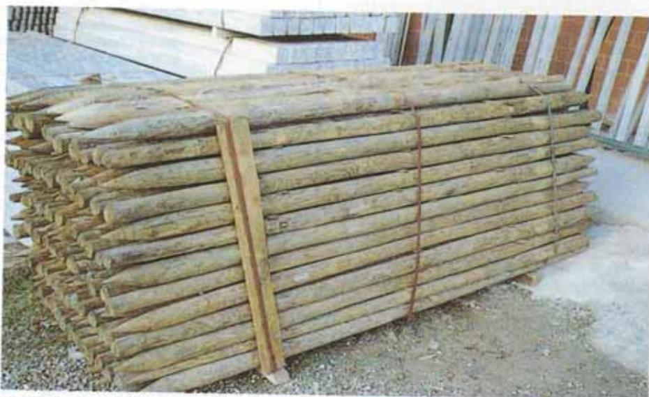
Figura 9 - Pali trattati in autoclave pronti per l'impiego (Consortium).
