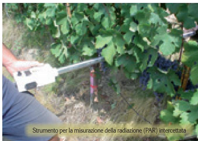
Strumento per la misurazione della radiazione (PAR) intercettata
