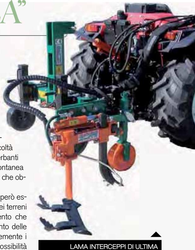
LAMA INTERCEPPI DI ULTIMA GENERAZIONE MONTATA SU TELAIO MULTIFUNZIONE (COLOMBARDO). POSSIBILE IL MONTAGGIO DEL DOPPIO ATTREZZO PER OPERARE SUI DUE LATI. ([www.colombardo.com](http://www.colombardo.com))
