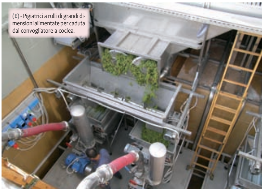
(D) - Alimentazione per caduta della pigiatrice a rulli (vinificazione in bianco).
