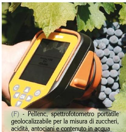
(F) - Pellenc, spettrofotometro portatile geolocalizzabile per la misura di zuccheri, acidità, antociani e contenuto in acqua
