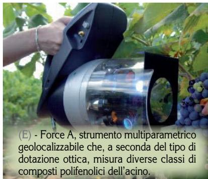
(E) - Force A, strumento multiparametrico geolocalizzabile che, a seconda del tipo di dotazione ottica, misura diverse classi di composti polifenolici dell'acino.
