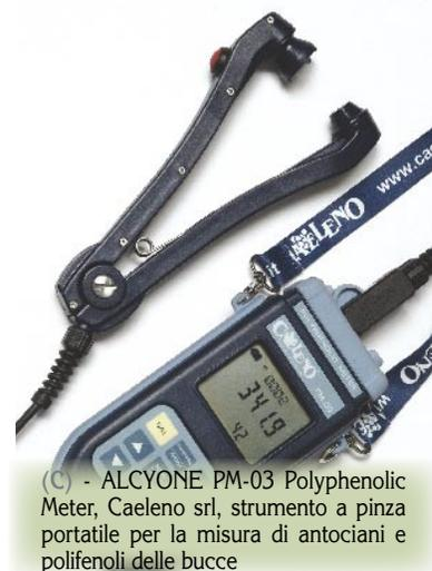
(C) - ALCYONE PM-03 Polyphenolic Meter, Caeleno srl, strumento a pinza portatile per la misura di antociani e polifenoli delle bucce
