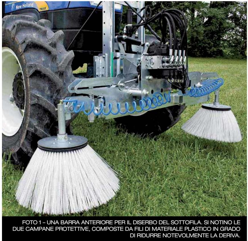
FOTO 1 - UNA BARRA ANTERIORE PER IL DISERBO DEL SOTTOFILO. SI NOTINO LE DUE CAMPANE PROTETTIVE, COMPOSTE DA FILI DI MATERIALE PLASTICO IN GRADO DI RIDURRE NOTEVOLMENTE LA DERIVA.
