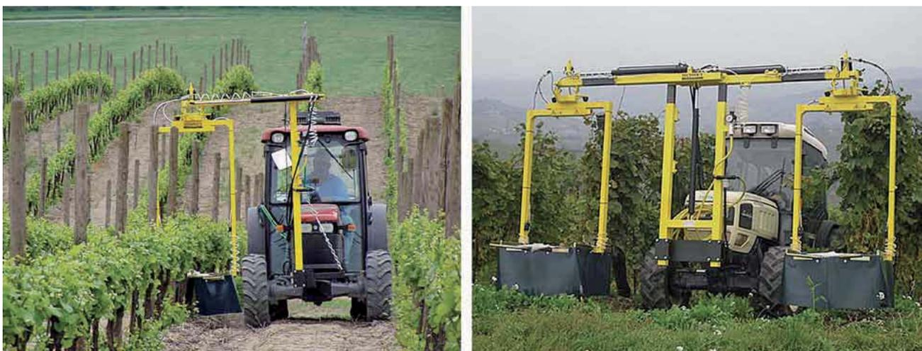
FOTO 2 - L'UNIONE DEL DISERBO SOTTOFILA ALLA SPOLLONATURA CHIMICA RIDUCE I CONSUMI DI COMBUSTIBILE E I TEMPI DI LAVORAZIONE PER ETTARO. DOVE POSSIBILE SI POSSONO UTILIZZARE ADDIRITTURA SPOLLONATRICI A DOPPIO CORPO, IN GRADO DI LAVORARE 2 FILARI PER VOLTA.
