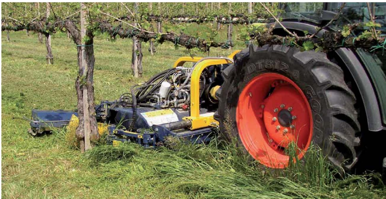
FOTO3 - IL DISERBO MECCANICO DEL SOTTOFILA VIENE SPESSO UNITO ALLO SFALCIO DELL'INTERFILA, COME IN QUESTO CASO. SI NOTI DAVANTI ALL'ORGANO LAVORANTE LA BACCHETTA METALLICA DEL SENSORE DI RIENTRO IDRAULICO.
