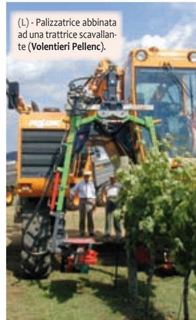
(L) - Palizzatrice abbinata ad una trattore scavallante (Volentieri Pellenc).
