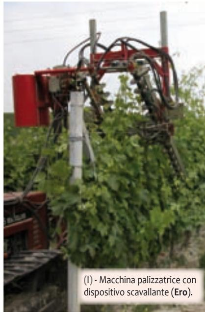
(I) - Macchina palizzatrice con dispositivo scavallante (Ero).
