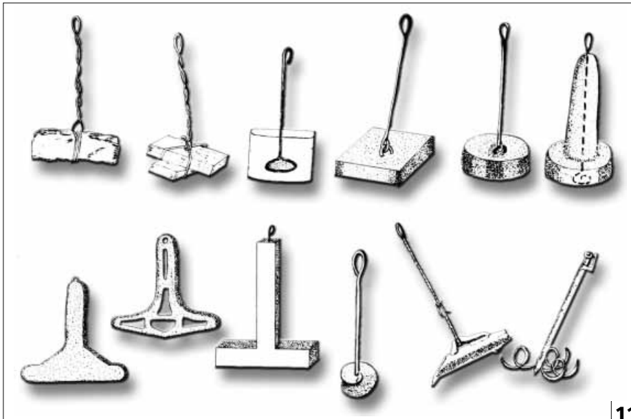
Foto 11 - Ancoraggi diversi realizzati in pietra, mattoni, cemento armato e ferro
