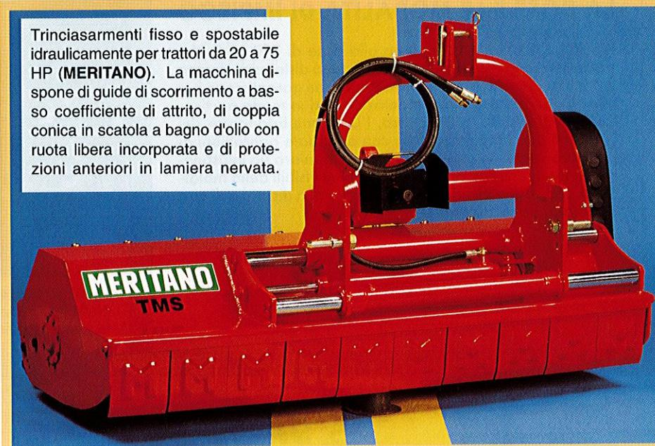
Trinciasarmenti fisso e spostabile idraulicamente per trattori da 20 a 75 HP (**MERITANO**). La macchina dispone di guide di scorrimento a basso coefficiente di attrito, di coppia conica in scatola a bagno d'olio con ruota libera incorporata e di protezioni anteriori in lamiera nervata.
