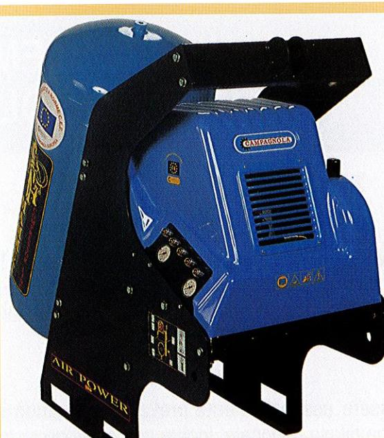
Compressore per forbici pneumatiche (**Campagnola**). La presenza del serbatoio con capacità di stoccaggio da 300 a 1000 litri di aria consente una notevole autonomia, riducendo al minimo i tempi in cui il trattore deve rimanere acceso. L'attacco a tre punti consente un rapido aggancio e sgancio dell'attrezzo.
