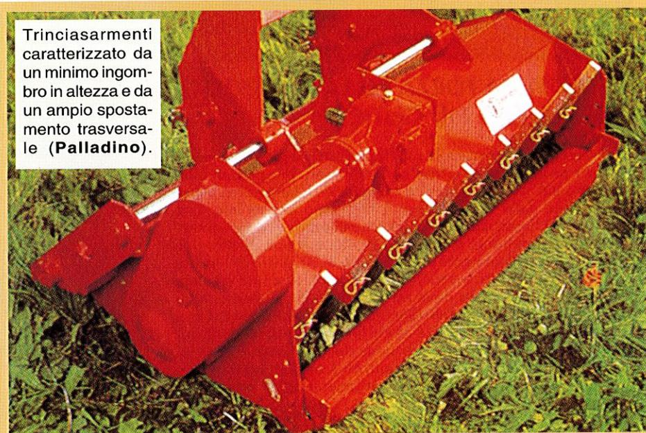
Trinciasarmenti caratterizzato da un minimo ingombro in altezza e da un ampio spostamento trasversale (**Palladino**).
