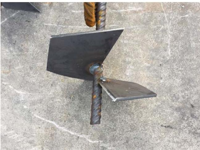
Dal punto di vista della tenuta a trazione è sufficiente un diametro molto inferiore, tanto è vero che negli ancoraggi prefabbricati viene usata un'asta da mm 14 perché non c'è nessuna necessità di avvitare.
